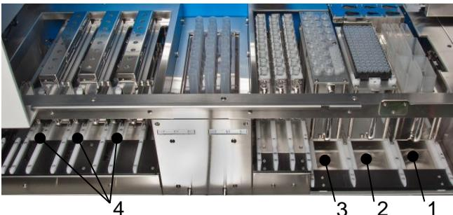
8) Ouvrez le couvercle de l'agitateur et placez les tubes de lysat sur l'unité de lysat dans le QuickGene-Auto240L (même nombre que le nombre d'échantillons) après avoir placé le tube de lysat et fermez le couvercle de l'agitateur.
