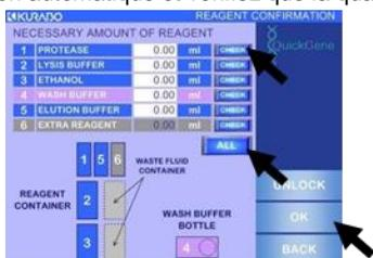
21) Appuyez sur [CHECK] pour un réactif confirmé. Si [ALL] est enfoncé, tous les boutons [CHECK] sont enfoncés en même temps.
