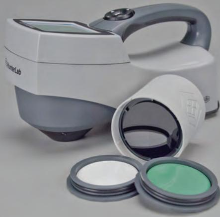
堅牢でコンパクトでポータブルなMiniScan® EZ分光測色計は工場、生産ライン、倉庫、野外などサンプルのあるところに持ち運べる便利な計測装置です。比類のない高い信頼性でサンプルの正確な色、二つのサンプルの色差、サンプルと標準の色差を測定します。全工業で使用されている反射率測定規格に合致し従来通りのデータ収集が可能です。
