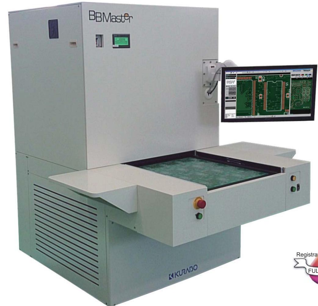
本システムは、高精度カラーラインセンサカメラでパッケージ・モジュール基板を撮像し、あらかじめ記憶した良品基準画像との照合によって、配線パターン部および基材の欠陥を高速かつ細密に検査する装置です。
