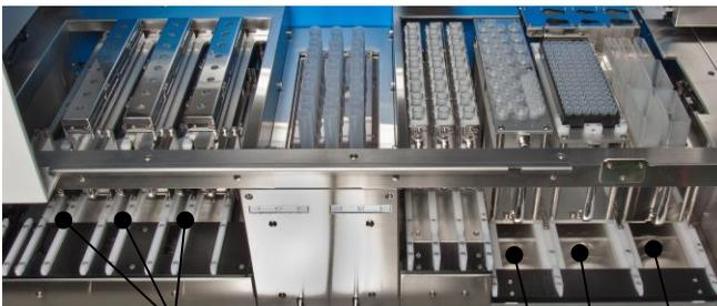
8) Aprire il coperchio dell'agitatore e sistemare le provette per lisato sull'apposita unità all'interno di QuickGene-Auto240L (stesso numero del campione). Una volta sistemata la provetta per lisato chiudere ermeticamente il coperchio dell'agitatore.
