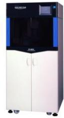
クラボウ PI-480a では一度に 48 サンプルの DNA の自動分離精製が可能です。本データでは、植物 DNA 2 プロトコールを用いた、大豆の種子からの DNA 分離精製例を示します。ヒーターユニット及び追加の送液ラインを増設することで、細胞の加温操作から DNA 溶解工程まで自動で実施することが可能です。
