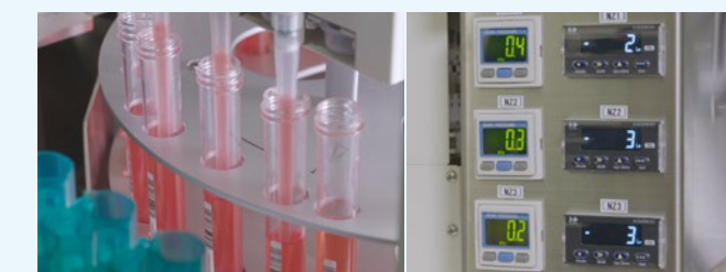
液面検知・目詰まり検知などの各種センサーを搭載
