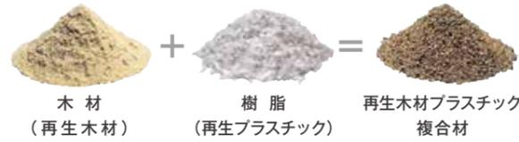
クラティスエコは、再生木材プラスチック複合材をクラボウ独自の一体押出成形技術でアルミ形材へコーティングし、サンディング仕上げにより木質感を表現した素材です。長期耐久性に優れ、軽量・高強度で、施工性にも長けており、高層物件から住宅、エクステリアまで幅広く使用されています。
