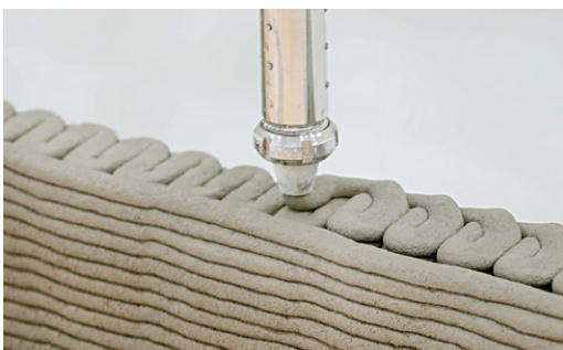
▲ロボットアームの先端ノズルから材料を吐出し積層
