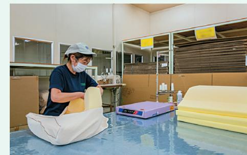
最終製品に上げるため、異物混入検査、検針を行い、品質を確認。合格品の出荷準備をします。
