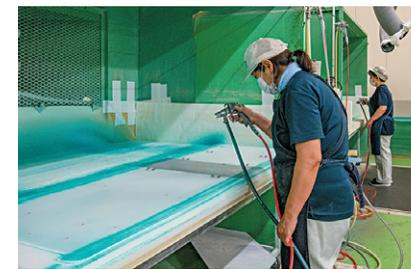
オーダーにあわせ、ウレタン、チップウレタン、他素材を組み合わせ接着成型していきます。
