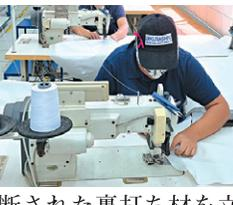
裁断された裏打ち材を立体的な金型に沿う形状に縫製します。検針機を通して完成です。
