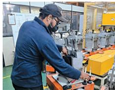
金型にトリムカバーを丁寧にセットし、ウレタン原料を注入します。
