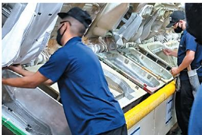
調合したウレタン原料を金型(モールド)に注入します。
