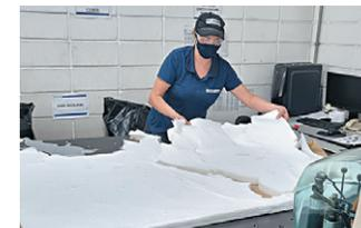
シート・モールドラインで使用する裏打ち材を裁断します。
