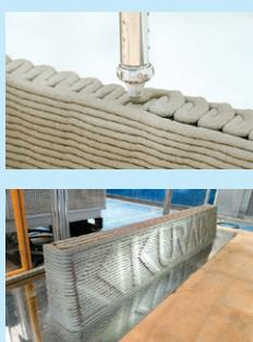
◀ロボットアームの先端ノズルから材料を吐出し積層
