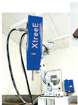
◀建設用3Dプリンター XtreeE（エクストリー）
