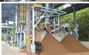
FUNTOは、家畜排せつ物（使用済み敷料、堆肥、等）を急速乾燥・瞬間殺菌する装置です。特殊構造の再生装置の中で、家畜排せつ物は熱風により乾燥・殺菌され、短時間で戻し堆肥（低水分堆肥）に生まれ変わります。
