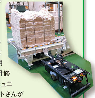
ルンリットさんが導入を実現させた綿の自動搬送機
