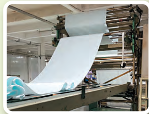
陶さんがバーナーの火力を微調整できるように改善したフレームラミネート加工の機械
