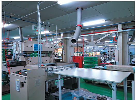
スプリッターでウレタンブロックを指定の厚みにしたシートを、コンベアで送り込み、連続でプレス裁断を行う。裁断品を箱に詰める際にバリ、欠け、破れに細心の注意を払いながら作業を行う。
