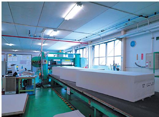
ブロック状のウレタンをスライスする機械。ウレタンを載せた作業台が前後することで刃と接触し、設定した厚みにスライス加工を行う。
