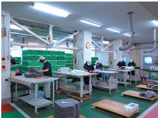
金型に裏面材をインサート成形する際に必要なメタルテープを裏面材に貼り付ける工程。（金型には裏面材が貼り付くように、マグネットが埋め込まれている）
