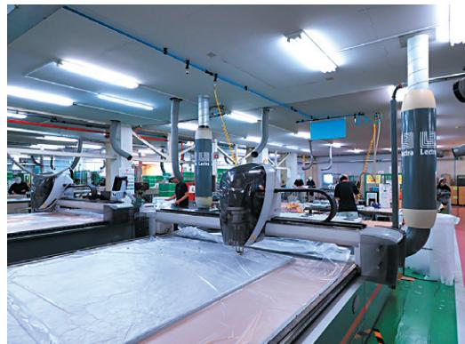
延反機で多層にした生地を、コンピューター制御により自動裁断を行う。
