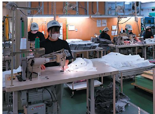
平面的な裏面材を立体的にするため、工業用ミシンで部分縫製を行う。
