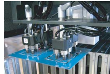
4点吸着パッド方式 Quadruple suction pads 4点吸着盘方式 4점 흡착 패드 방식
