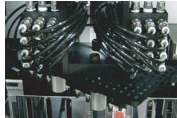
多列吸着パッド方式 Multiple suction pads 多列吸着盘方式 다열 흡착 패드 방식
