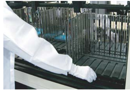
基板投入ストッカー The cartridges to supply PCBs. 电路板投入架框 기판 투입 로더
