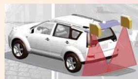
■ 路面検査・トンネル検査システム
